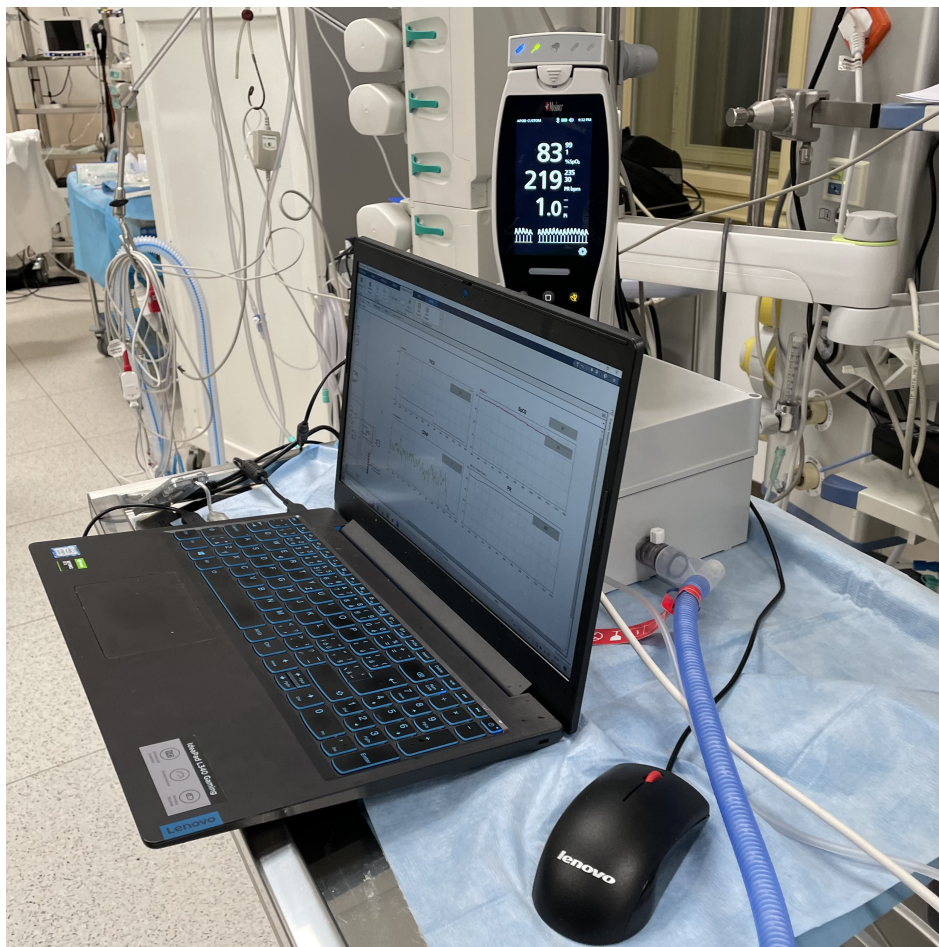
Obrázek 3.5: Fotografie realizace systému: řídicí počítač, pulzní oxymetr Masimo Radical 7 a box s pneumatickou a elektronickou částí systému.
