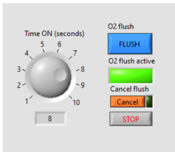
Obrázek 5.6: Čelní panel uživatelského prostředí pro ovládání O 2 -FS vytvořeného v programovém prostředí LabView.
