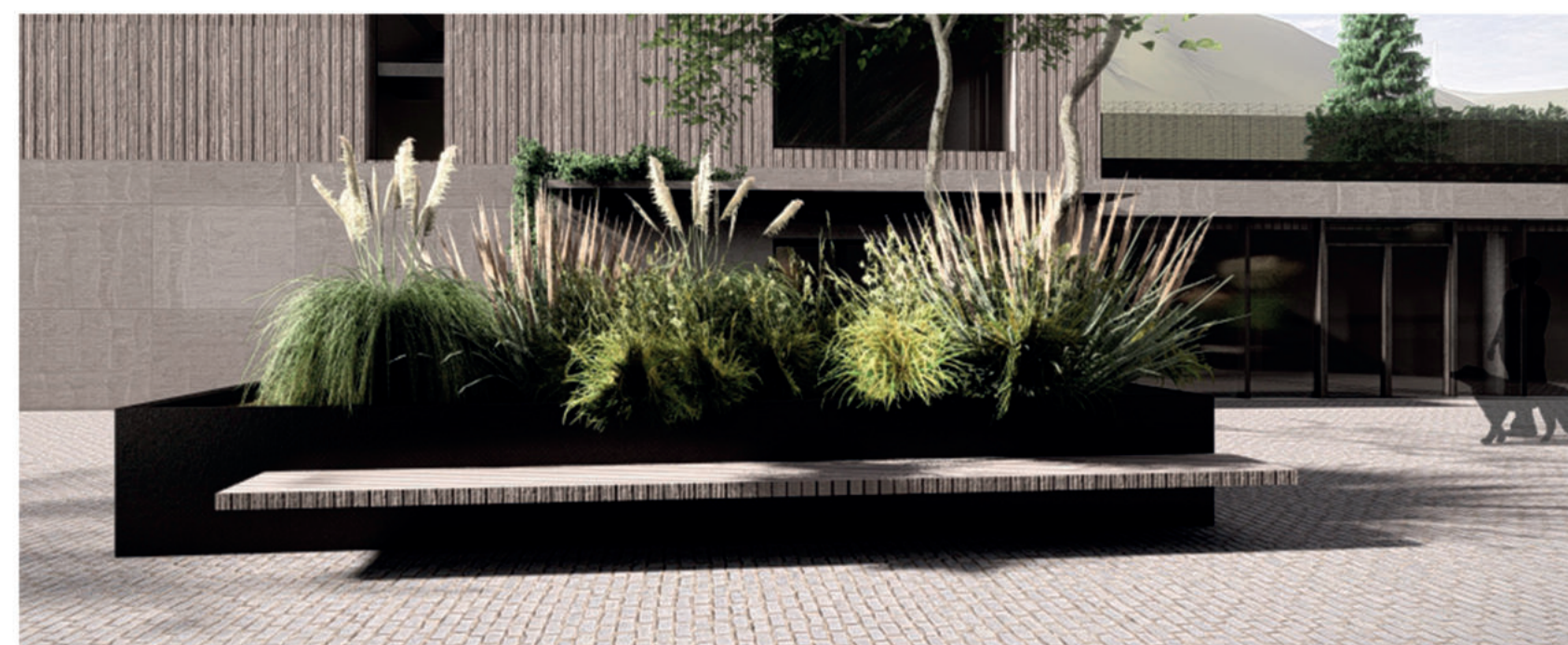
LAVIČKA ROZDĚLUJÍCÍ PĚŠÍ PROSTOR PRÁŠKOVĚ LAKOVANÁ OCEL, ČERNÁ DŘEVĚNÝ SEDÁK SIBIŘSKÝ MODŘÍN
