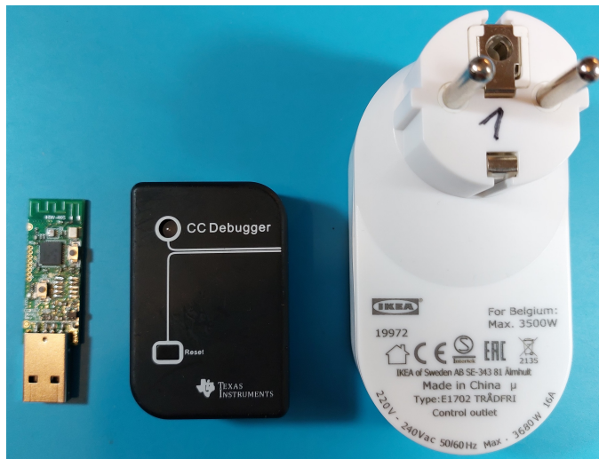
Obrázek 4.13: Použité příslušenství: koordinátor, programátor a ZigBee zásuvka
