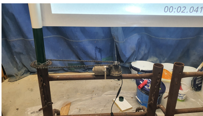
Obrázek 2.25: Detail vyřešeného pohonu.
