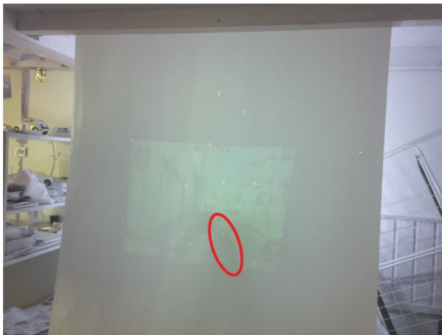
Obrázek 2.9: Ukázka použití osvětlení ze zadní části s difuzní clonou. A vyznačenými neosvětlenými ranami.
