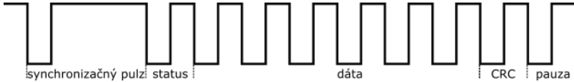
■ Obr. 1.1 Jeden rámec správy SENT s voliteľným pauzovacím pulzom
