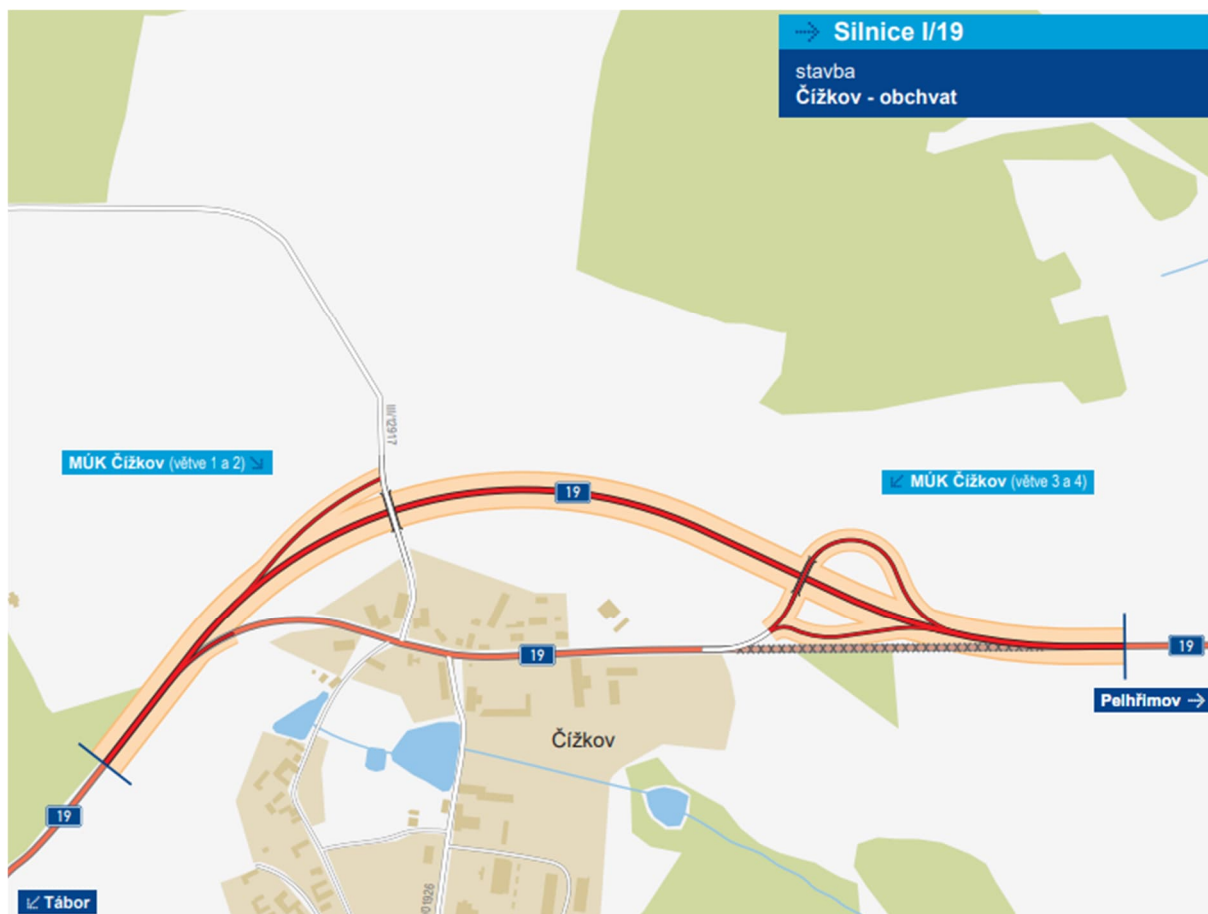
Obrázek 10 - Stavba I/19 Čížkov – obchvat (21)
