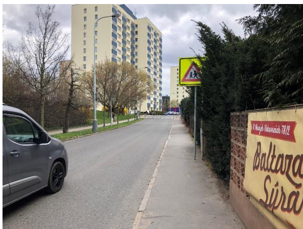
Obr. 39: Úsek č. 7 - Zeď zakrývá svislé dopravní značení 54
