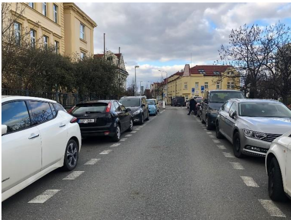
Obr. 72: Úsek č. 63 - Nedostatečný průjezdný profil 87
