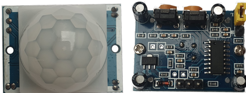
■ Obrázek 3.5 Modu senzoru pohybu HC-SR501
