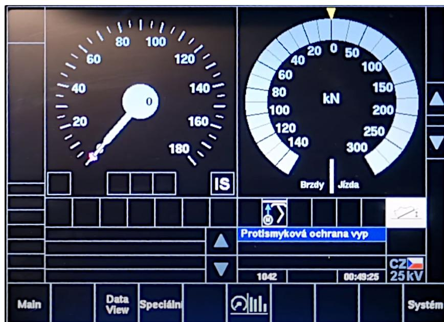
**Obrázek 2.9** Výchozí obrazovka DMI lokomotivy Traxx MS2 z videa z kabiny[9]
