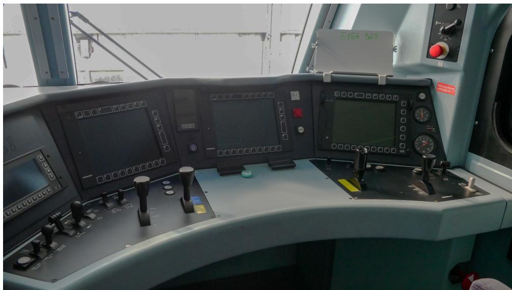
**Obrázek 2.3** Panel strojvedoucího na lokomotivě Bombardier Traxx MS2 [7]
