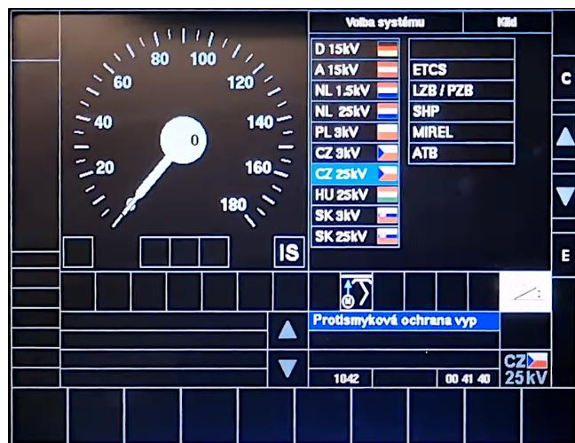
■ Obrázek 2.12 Obrazovka nastavení napájecího a zabezpečovacího systému na Traxx MS2 [9]
