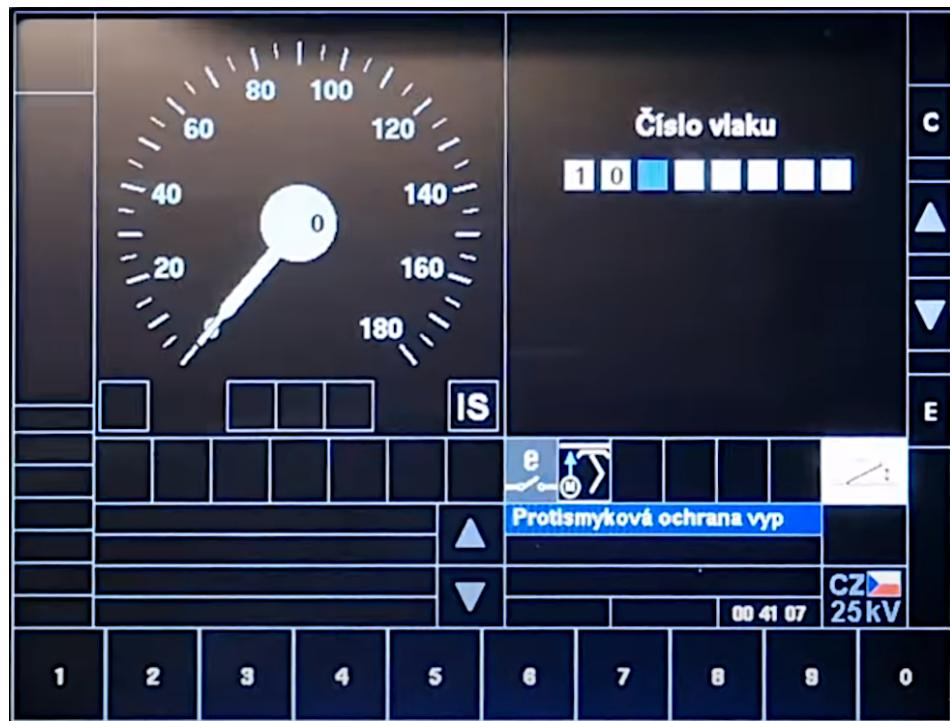
**Obrázek 2.17** Obrazovka zadání čísla vlaku na lokomotivě Traxx MS2 [9]
