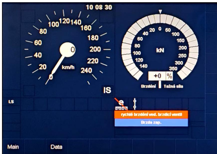
**Obrázek 2.10** Výchozí obrazovka DMI lokomotivy Vectron z videa z kabiny[14]
