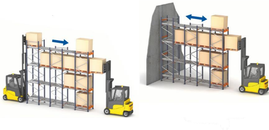
Obrázek 9: Metody uskladnění FIFO a LIFO (zdroj: (6))
