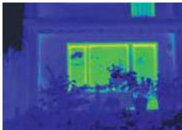
Obrázek 2 Zateplený dům s vhodným zasklením
