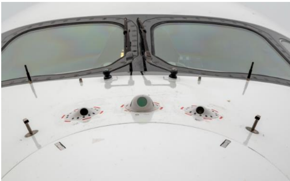
Obrázek 4: Technologický demonstrátor s dodatečnými senzory v přední části letounu.
