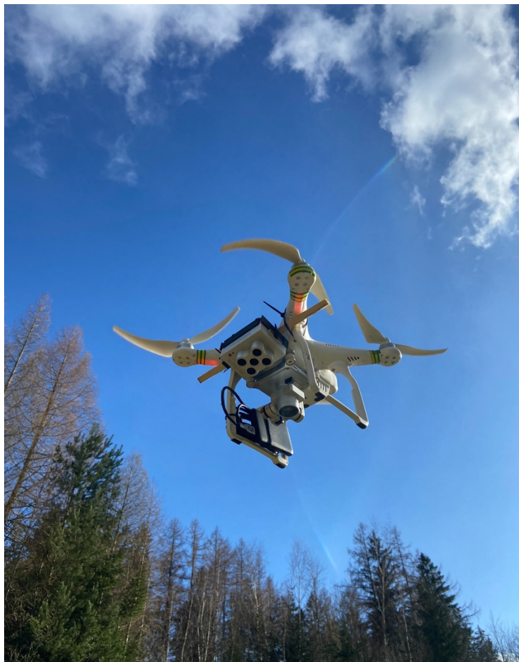
Obrázek 2.6 – používaný dron DJI Phantom 3 Professional vybavený multispektrální kamerou MicaSense RedEdge-MX
