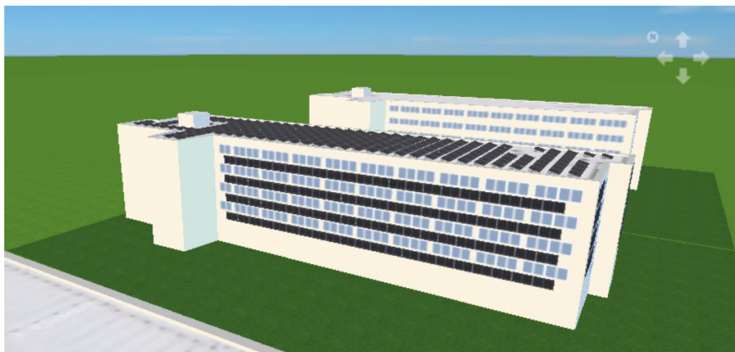
Obrázek 3-9: Maximální uvažované pokrytí bloku FV panely [1]
