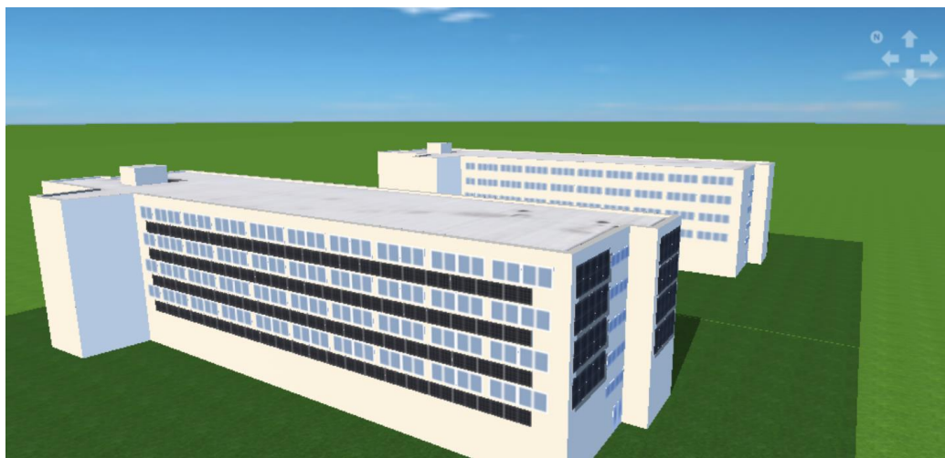
Obrázek 3-7: Pokrytí bloku nástěnnými FV panely ve 4 řadách
