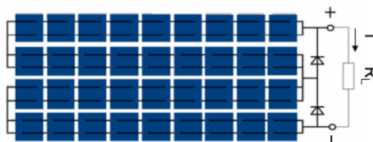
Obrázek 2-2: Schéma zapojení FV modulů [10]
