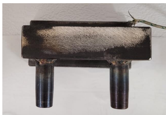
Obr. 17: přípravek pro ochlazení elektrod
