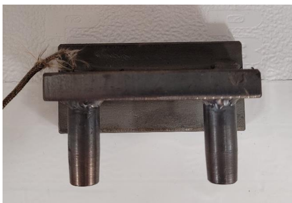
Obr. 16: přípravek pro ohřev elektrod
