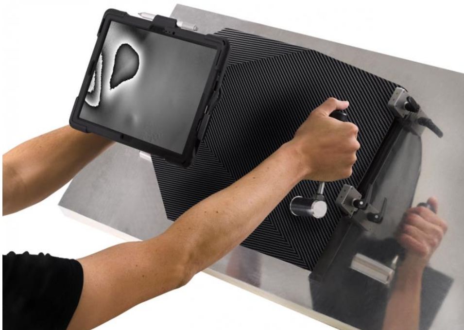
Obr. 11: Přenosná souprava pro provedení shearografické kontroly materiálu [25]
