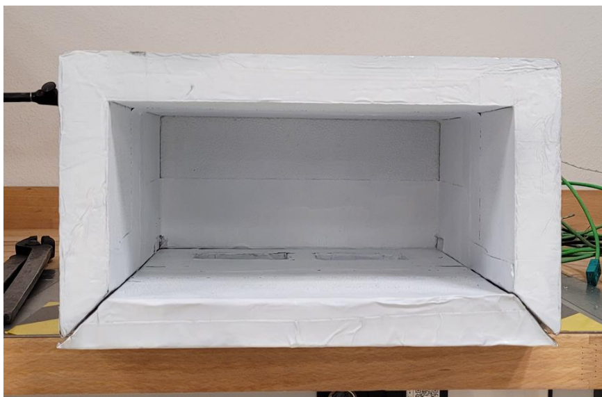
Obr. 19: Přípravek pro odstínění parazitního záření
