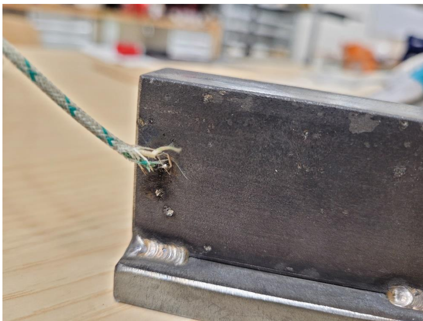
Obr. 23: Termočlánek navařený na ochlazovací přípravek
