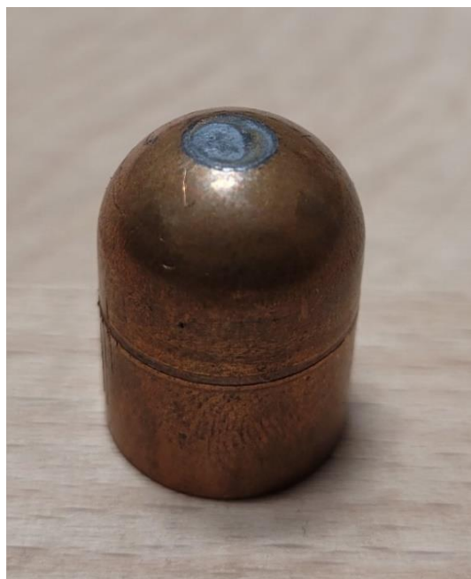
Obr. 22: Elektroda po 10 svařovacích cyklech, žárově zinkovaný svařovací materiál
