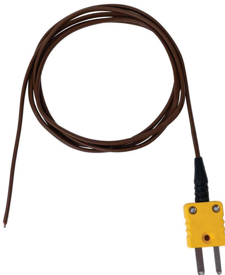
Obr. 5: Termočlánek typu K [13]
