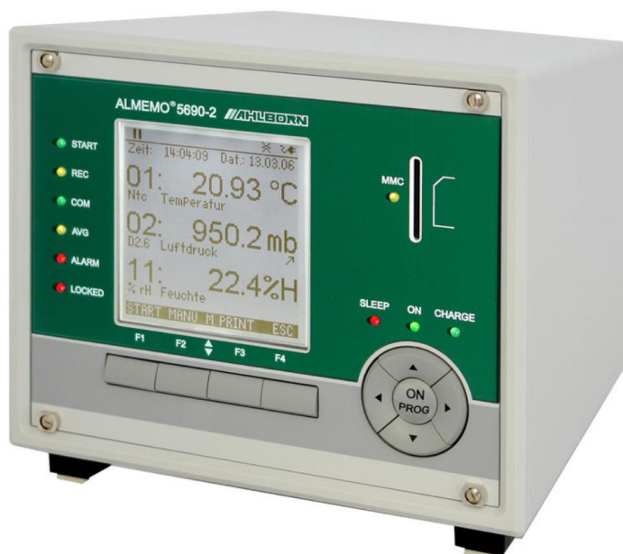
Obr. 13: Univerzální vícekanálová měřicí ústředna ALMEMO 5690-2M [27]
