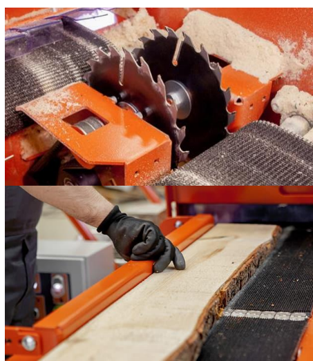
Obr. 6 - Omítací pila se dvěma kotouči a pásovým posuvem [37]
