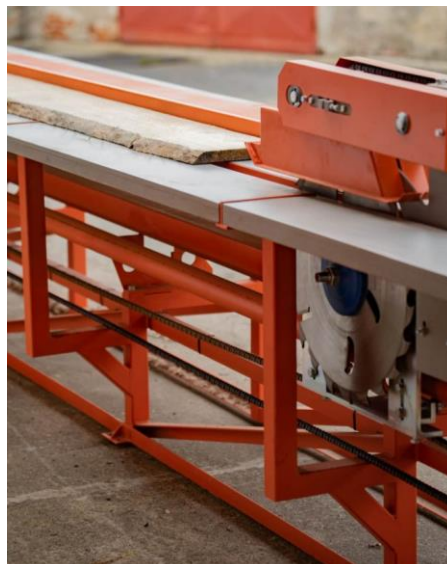
Obr. 5 - Omítací pila s posouvajícím se kotoučem [38]
