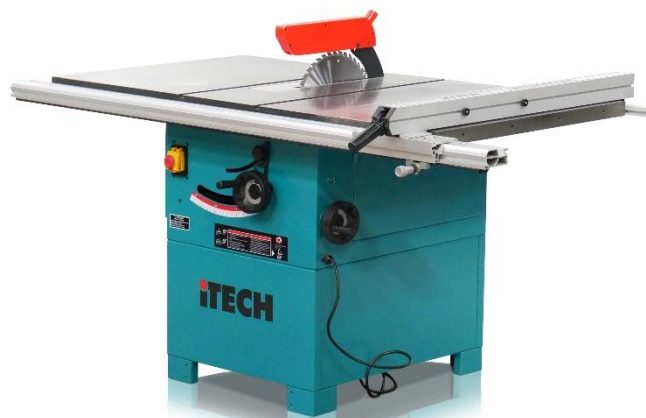
Obr. 9 - Stolní pila s podélným pravítkem [39]
