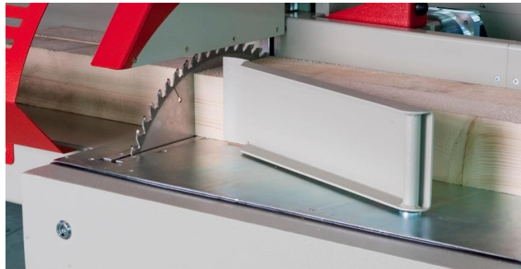
Obr. 8 - Zkracovací pila se strojním posuvem kotouče ze spodní strany (s přidržovačem materiálu) [7]
