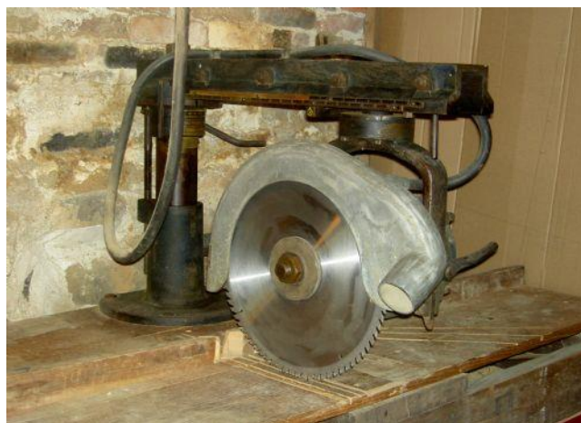
Obr. 3 - První pila s radiálním ramenem od společnosti DeWalt z roku 1922 [36]
