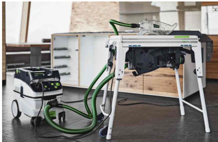
Obr. 18 - Stolní pila s horním i dolním odsavačem pilin [17]
