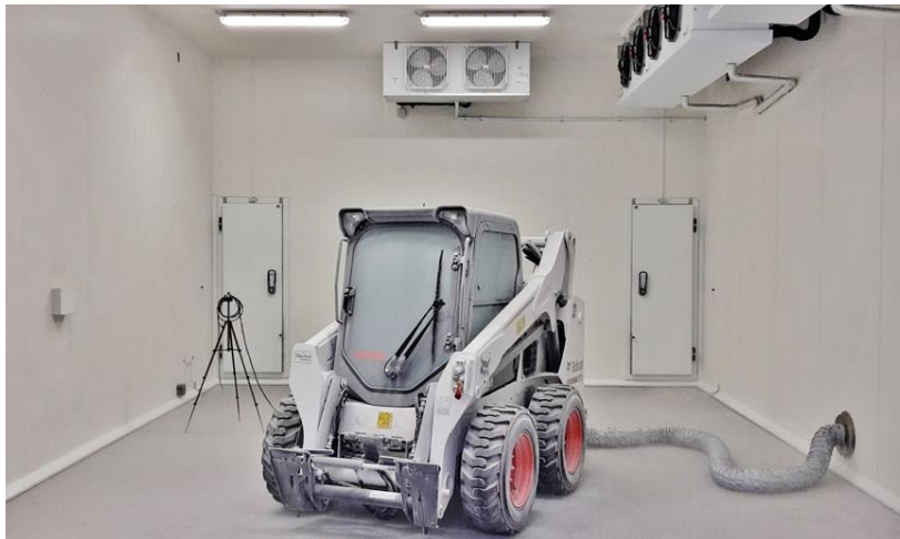
Obrázek 19: Test studeného startu v chladicí komoře [28]
