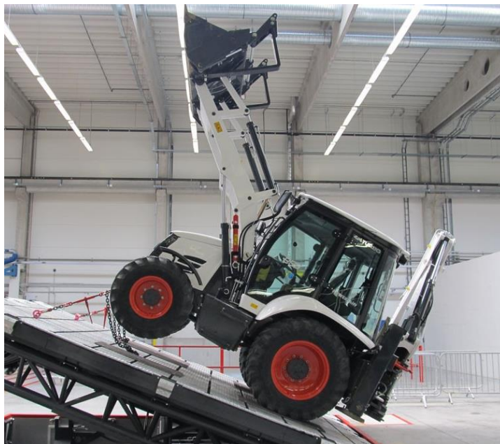
Obrázek 20: Test na naklápěcí plošině [28]
