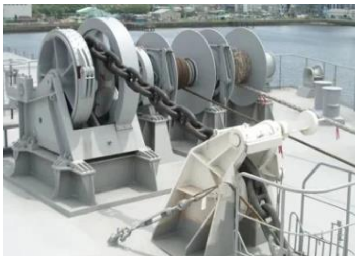
Obrázek 9: Lodní naviják s řetězem, ocelovým lanem a provazem [15]
