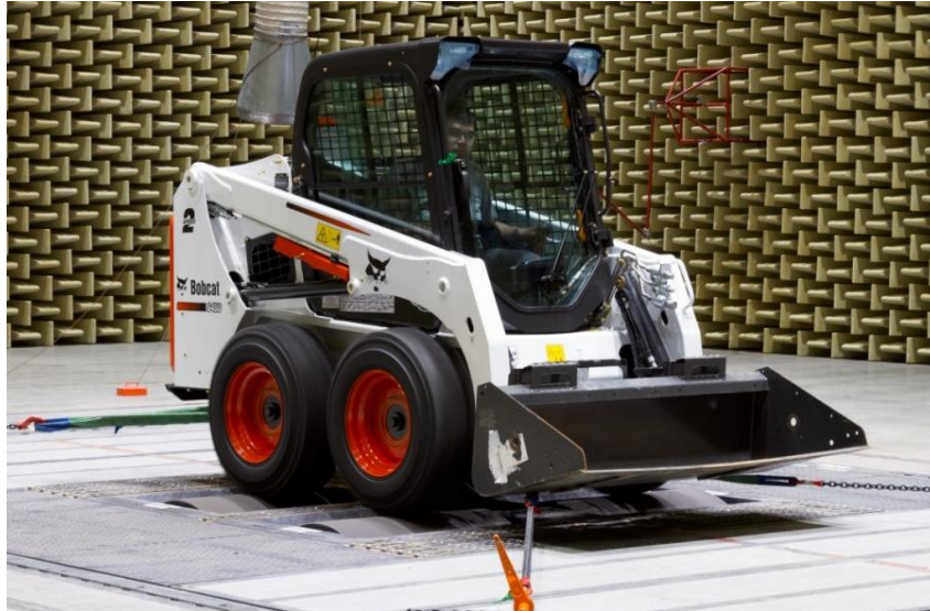
Obrázek 21: Testování hluku nakladače během jízdy [28]
