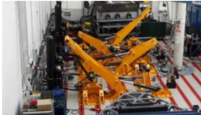
Obrázek 22: Cyklické testování hydraulických válců [32]
