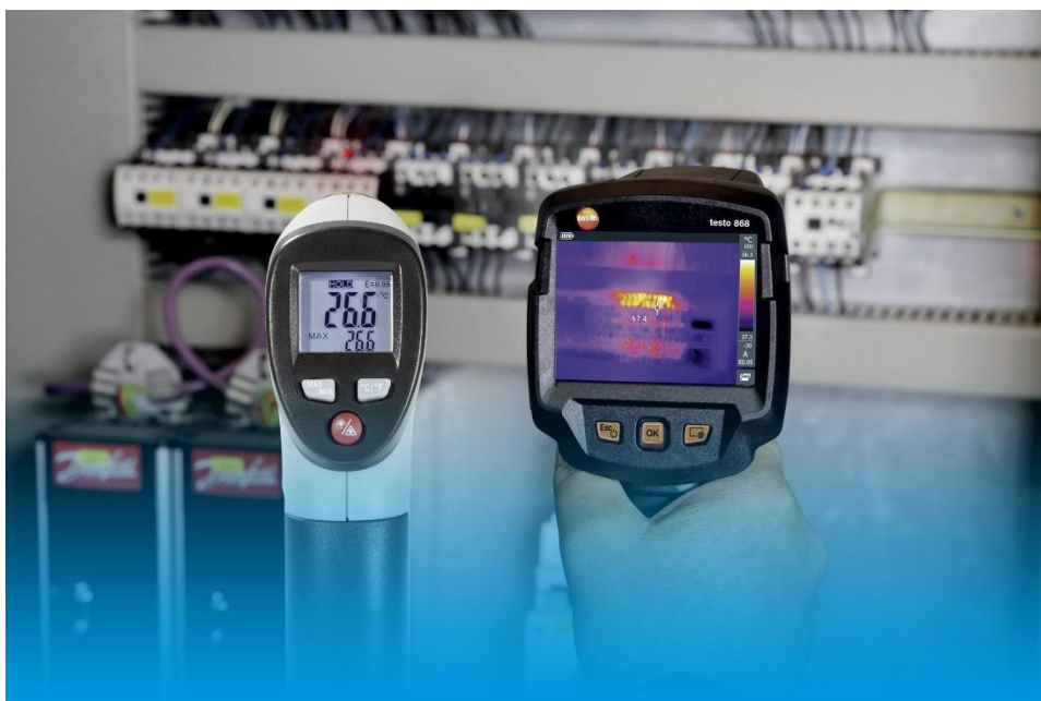
Obrázek 2 - Bezkontaktní měření teploty pyrometrem a termokamerou
