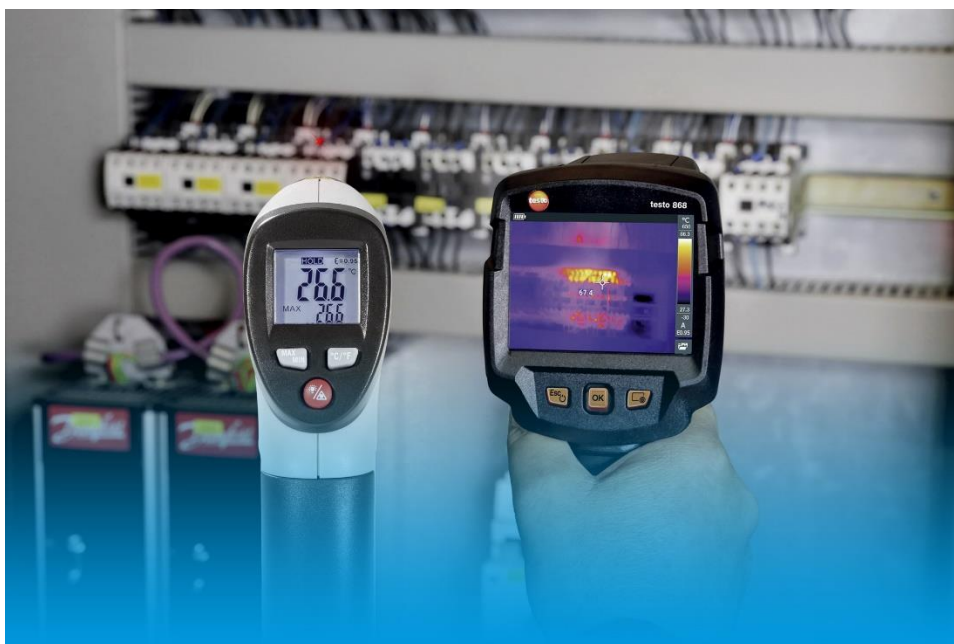
Obrázek 2 - Bezkontaktní měření teploty pyrometrem a termokamerou
