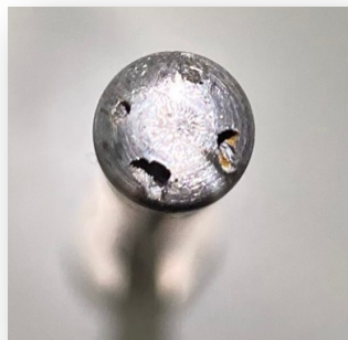
Obrázek 28: Poškozená tryska D8 po limitním testu
