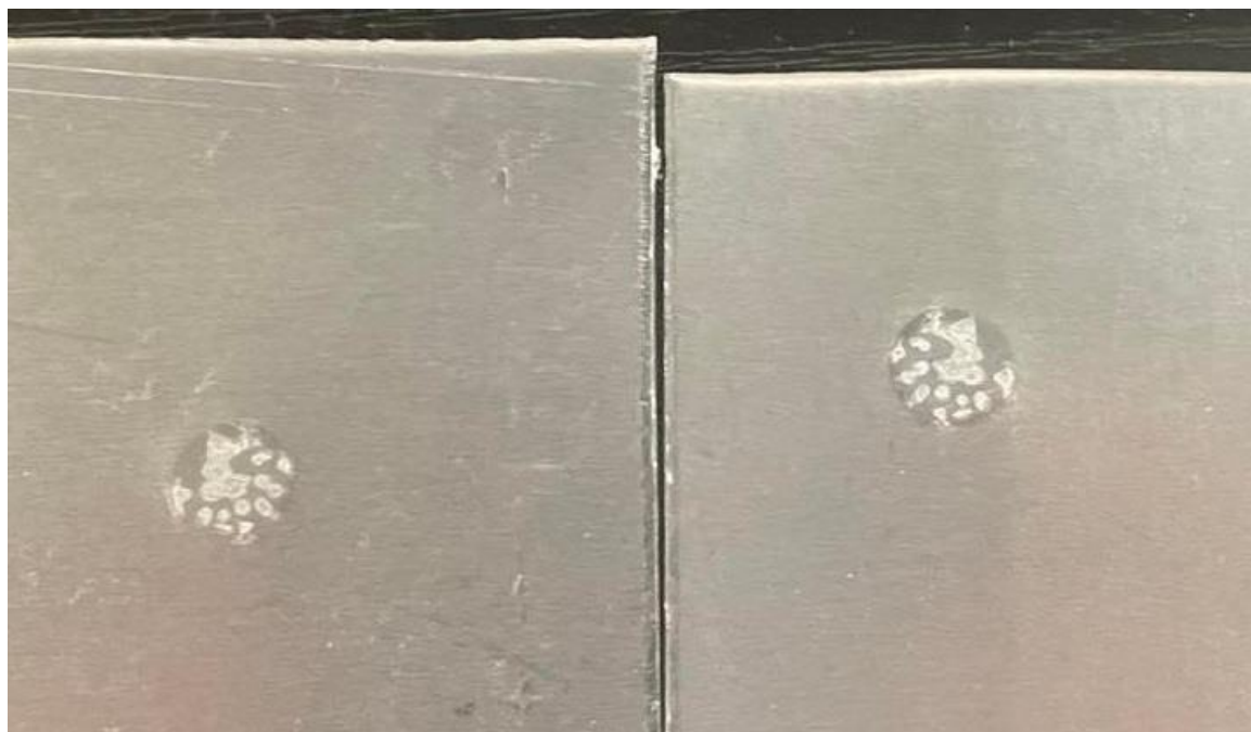
Obrázek 16.: Svar č. 24 s náznakem tavení svarové čočky
