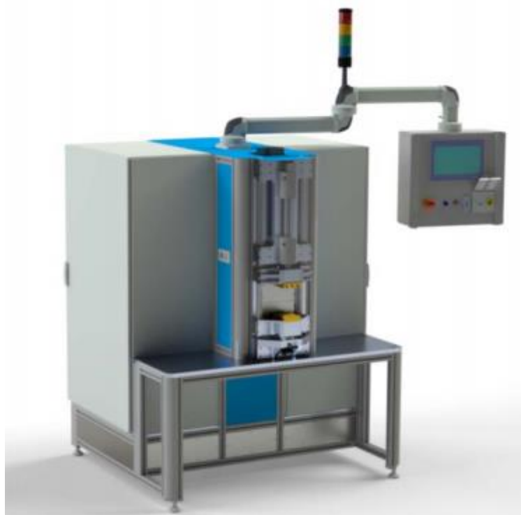
Obrázek 14.: Dalex – PrimKo 04, kondenzátorový svařovací stroj [28]
