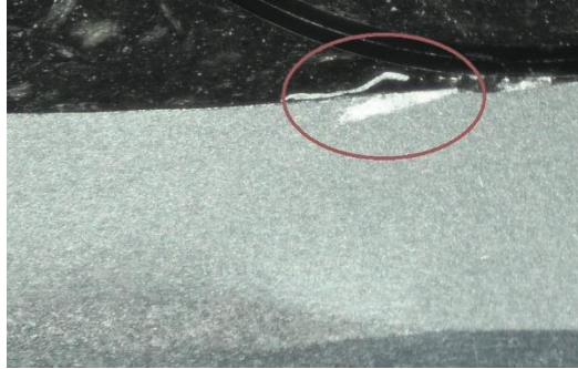
Obrázek 19.: Oblast křehkosti tekutého kovu u svařence č. 49
