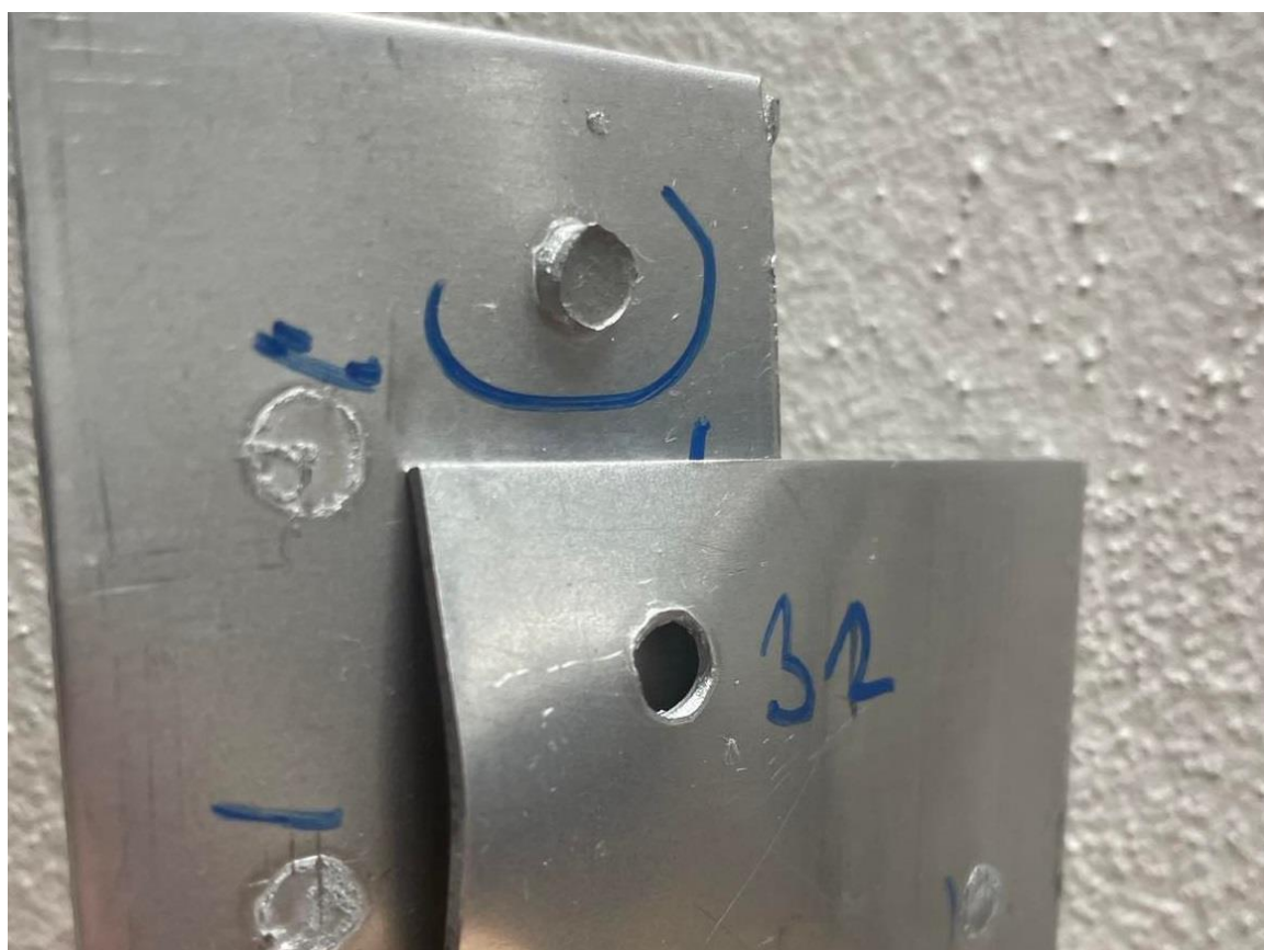
Obrázek 17.: Svar č. 32 s vytrženou svarovou čočkou
