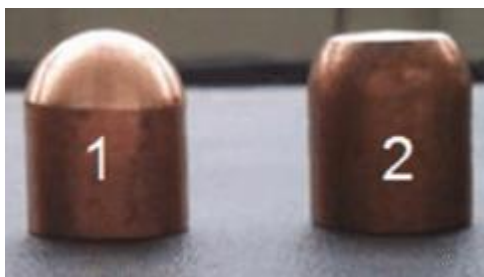
Obrázek 21.: Čepička s kulovou plochou (vlevo) a mírně zaoblenou, v dosedací ploše rovnou (vpravo) [30]
