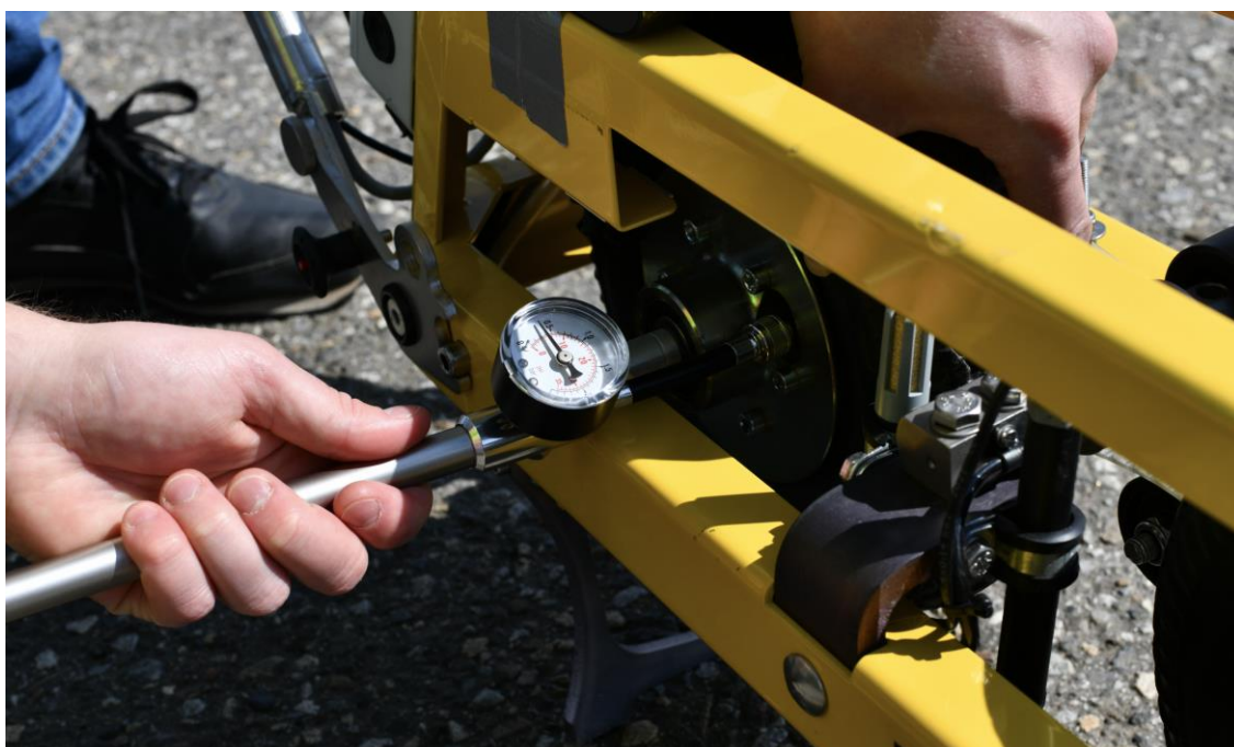
Obrázek 22 – Kontrola tlaku pneumatik skidometru T2GO v průběhu kalibrace
