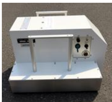
Obrázek 16 - Dynamické zařízení pro měření adheze (zdroj: [5])
