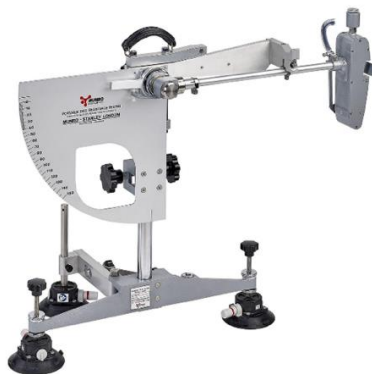
Obrázek 15 - Kyvadlový přístroj pro měření adheze (zdroj:[3])
