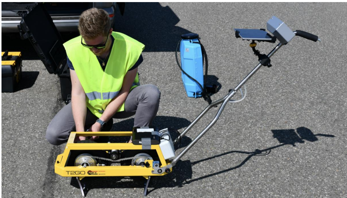
Obrázek 27 - Příprava skidometru T2GO před začátkem měřících prací
