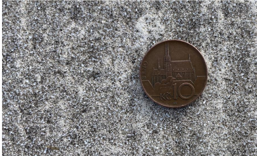
Obrázek 33 - Charakteristický snímek VDZ s balotinovým posypem 5F
