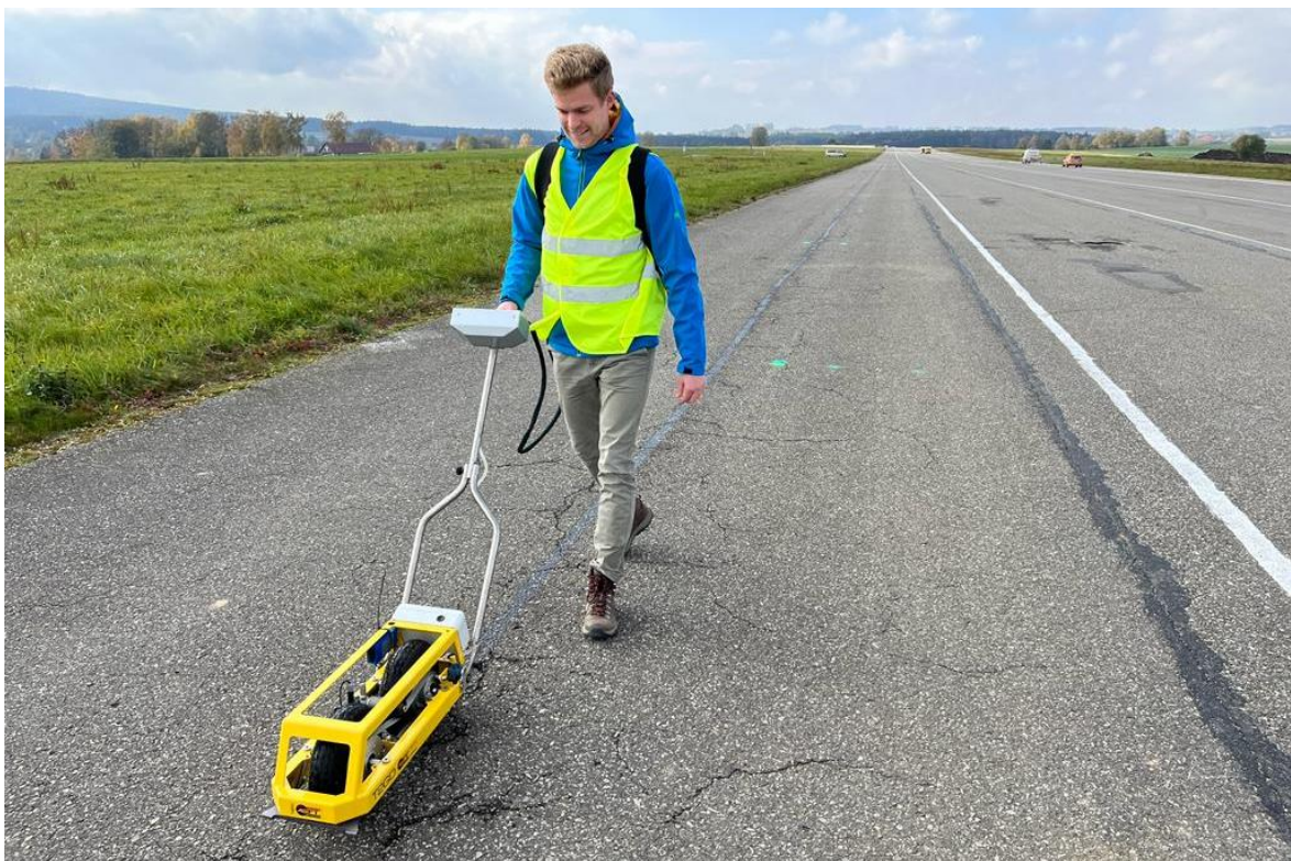
Obrázek 29 - Průběh měření skidometrem T2GO
