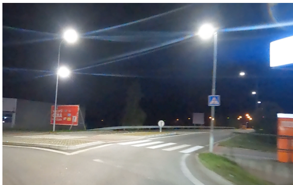
Obrázek 55 – Adekvátní přisvětlení přechodu pro chodce. [5]
