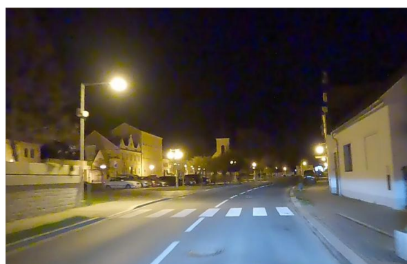
Obrázek 42 – Neadekvátní přisvětlení přechodu pro chodce (PLZ | ID 5732). [5]
