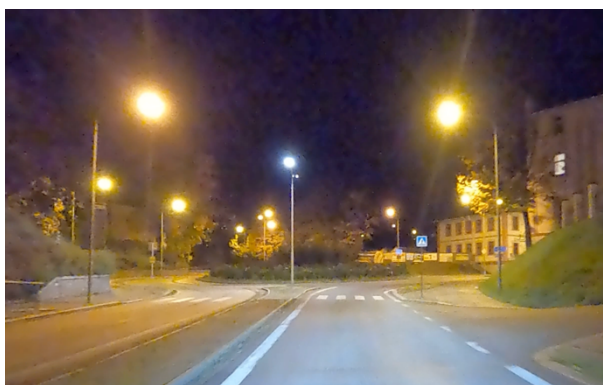
Obrázek 50 – Adekvátní přisvětlení přechodu pro chodce. [5]
