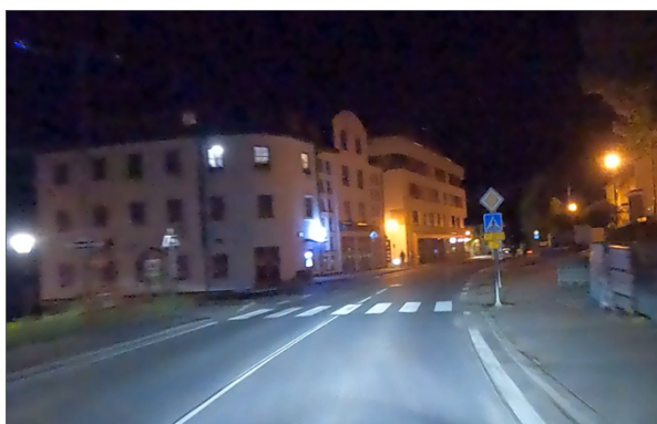
Obrázek 9 – Neadekvátní světelně-technické vlastnosti SDZ (PLZ | ID 6441). [5]
