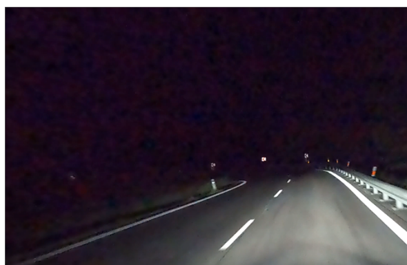
Obrázek 21 – Neadekvátní světelně-technické vlastnosti DZ (PLZ | ID 8463). [5]
