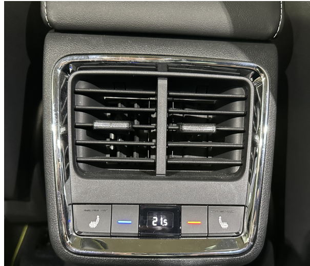
Obrázek 5.2. Ovládací panel 3. zóny
