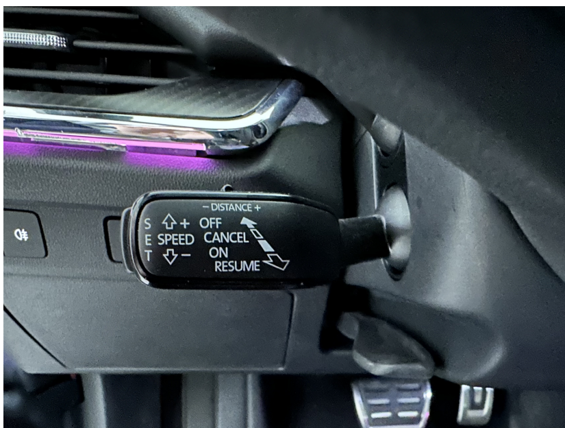
Obrázek 7.1. Páčka nastavení adaptivního tempomatu
