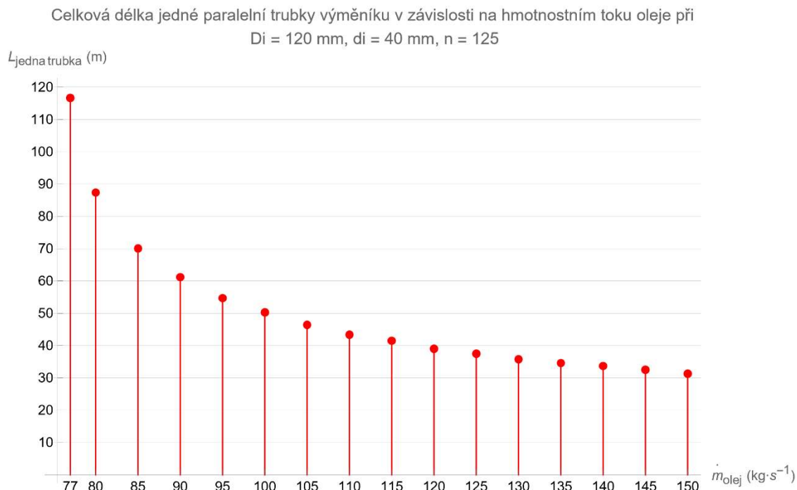
Graf 7.24 Závislost optimální délky jedné paralelní trubky výměníku na hmotnostním toku oleje ( D_i = 120 , d_i = 40\text{ mm} , n = 125 )
