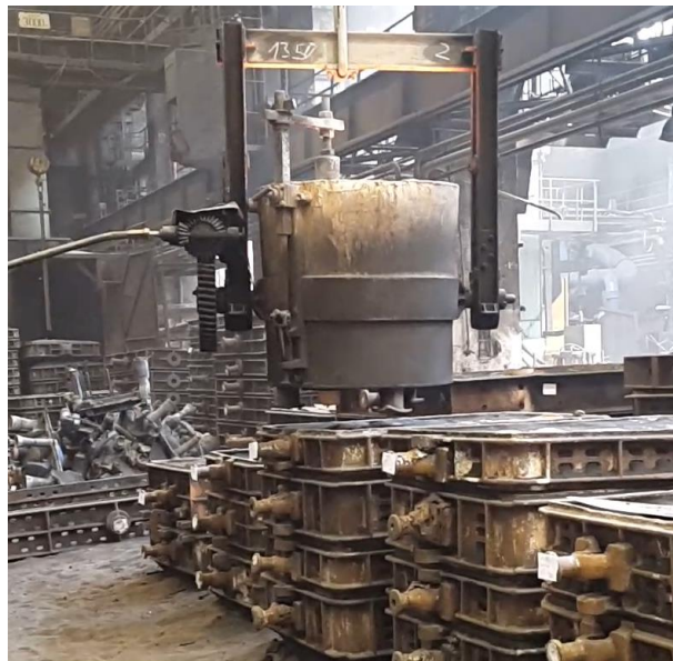
Obr. 6-8 Odlévání z pánvi s dolní výpustí
