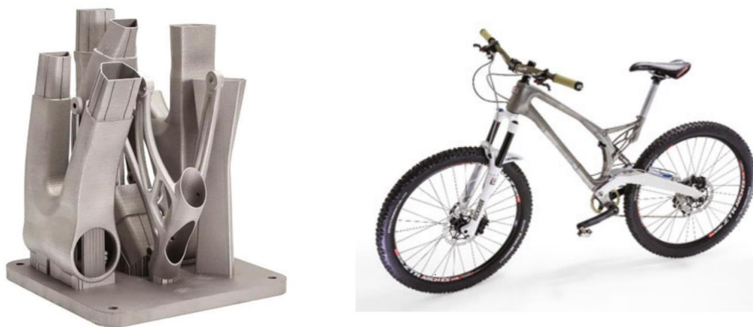
Obr. 3-2 Titanová konstrukce kola ihned po vytištění (nalevo) a po složení (napravo) (3)
