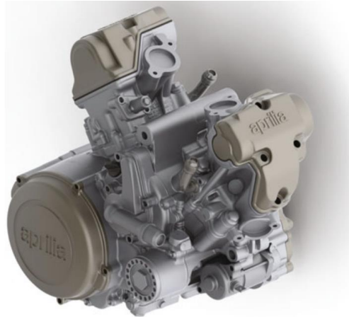
Obr. 3-9 příklad naskenované součástky převedené na model v CAD (3)
