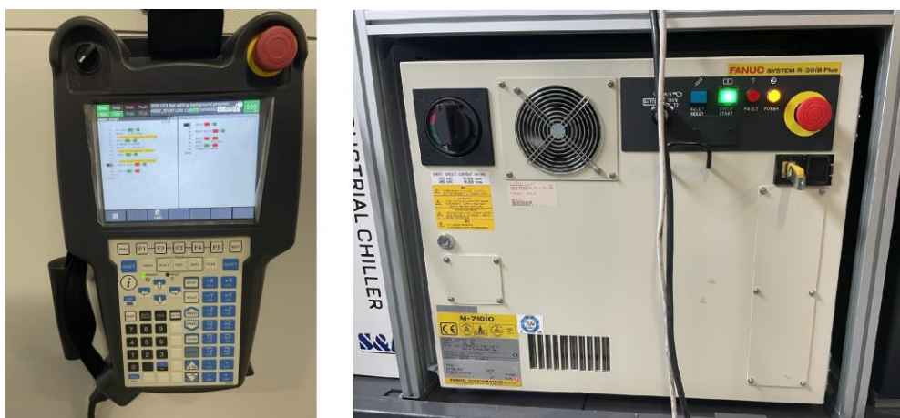
Obr. 5-3 Řízení pro Fanuc M-710ic70: Ovládací panel – Fanuc iPendant (nalevo) a kontrolér R-30iB MATE (napravo)
