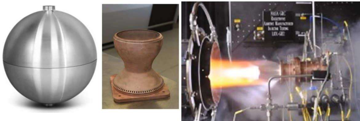
Obr. 3-4 palivová nádrž z titanu, raketová tryska z mědi, testování měděné trysky vyrobené pomocí aditivní výroby (3)
