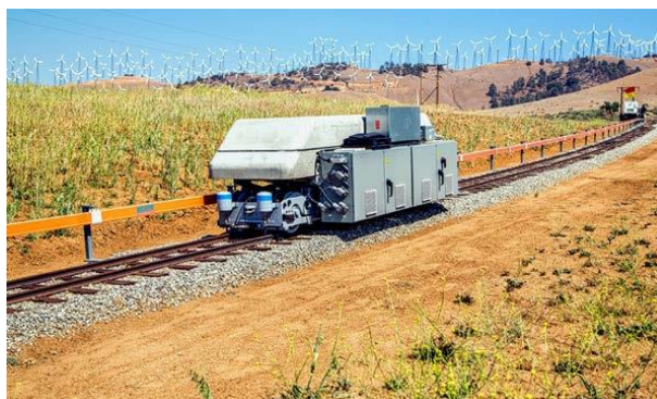
Obrázek 23: Testovací vozík projektu ARES [24]
