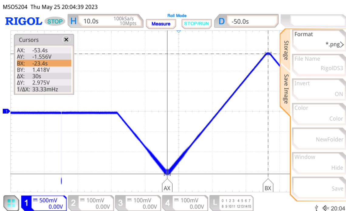
Obrázek 3.2- Měření průběhu na osciloskopu s rychlostí 100 \text{ mV} \cdot \text{s}^{-1}
