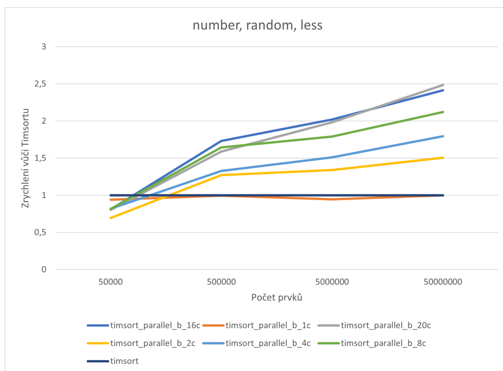
Obrázek 4.23: Zrychlení timsort_parallel_b oproti timsortu v závislosti na počtu vláken, náhodná čísla
