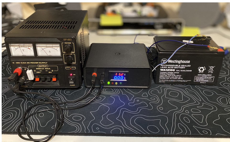
Obrázek 5.1: Měřicí stanoviště pro kontrolu funkce
