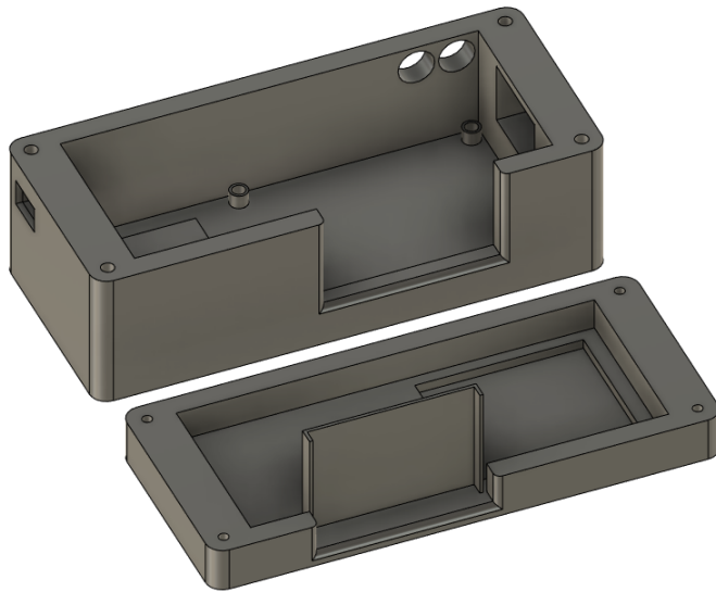
Obrázek 3.10. 3D model pouzdra na zdroj.
