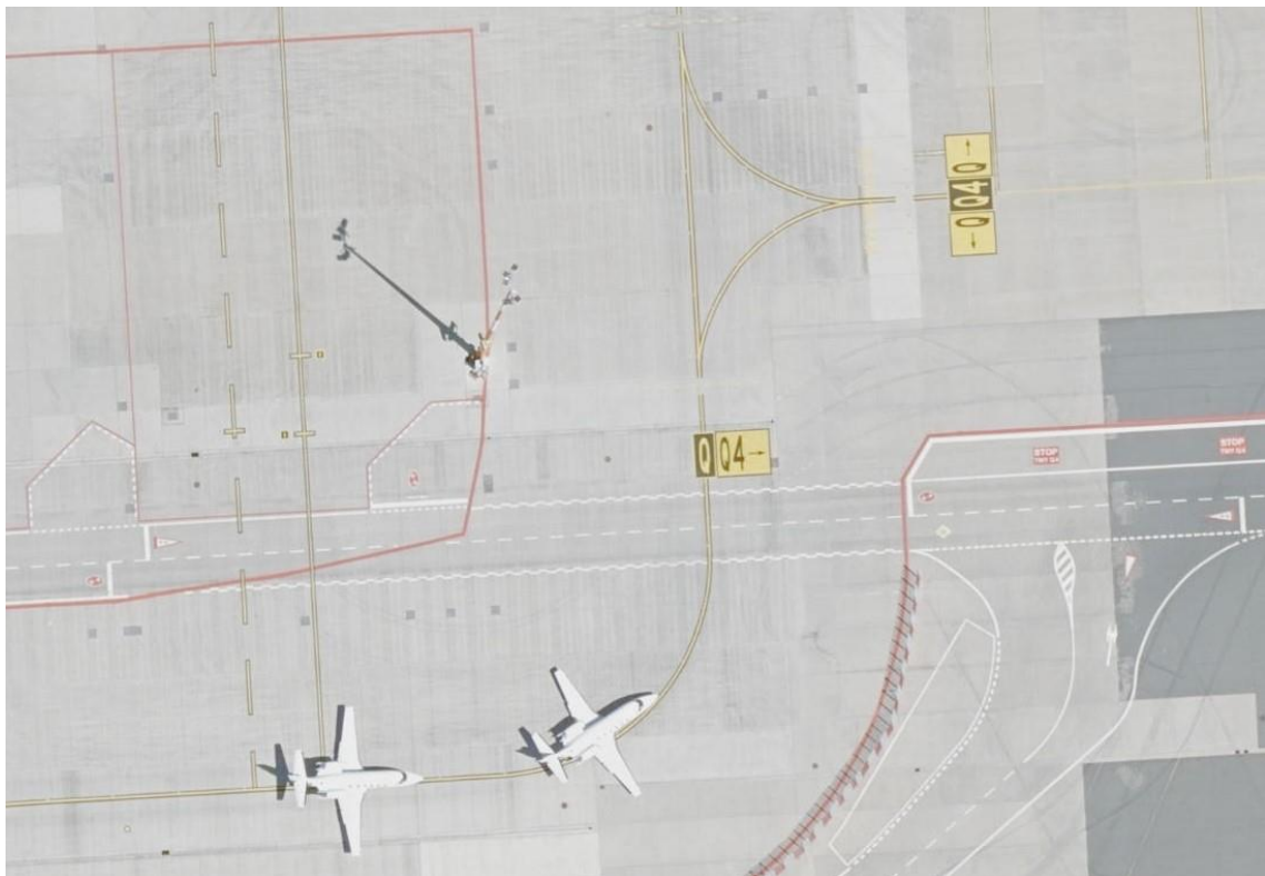
Obrázek 5 Příklad značení TWY, obslužné komunikace a odbavovací stání letadel průjezdného typu [12]
