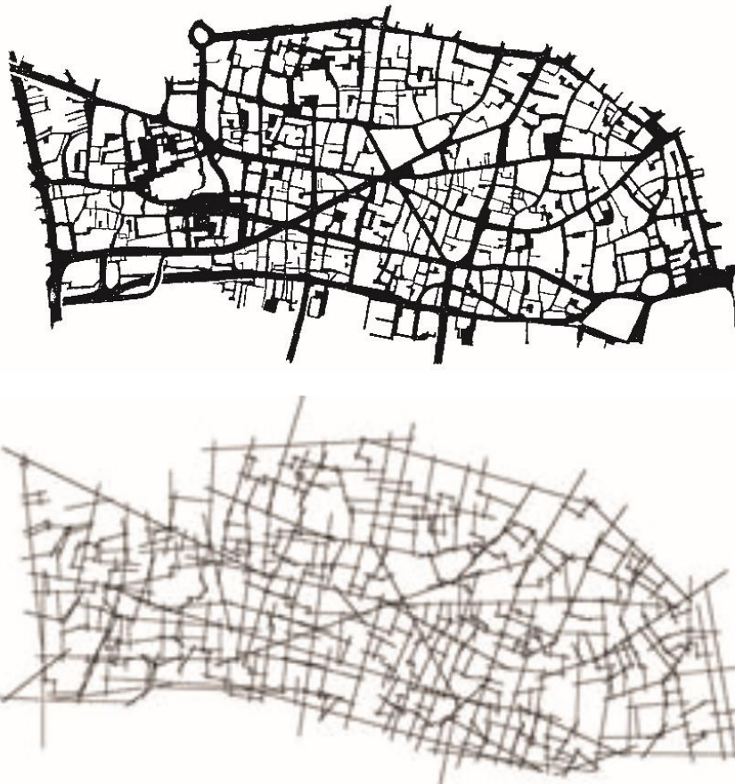
Obr. 16 Příklad konstruování axiální reprezentace veřejného prostoru sídla, Bill Hillier, Space is the Machine , 2007, s. 117
