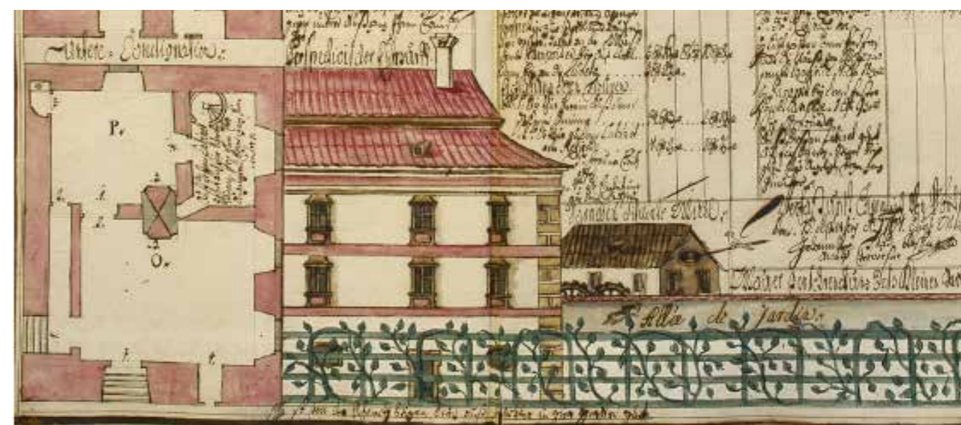
Východní část zámeckého nádvoří. Loubí vede od postranního vchodu do zámku jižním směrem do zahrady. Je vyrobeno z dřevěných planěk a natřeno zelenou olejovou barvou. J.T. Košin; po roce 1670)
