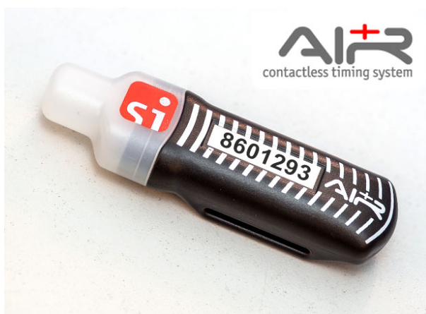
Obrázek 2.3. Závodníková jednotka od společnosti SPORTIdent. Převzato z [3].
