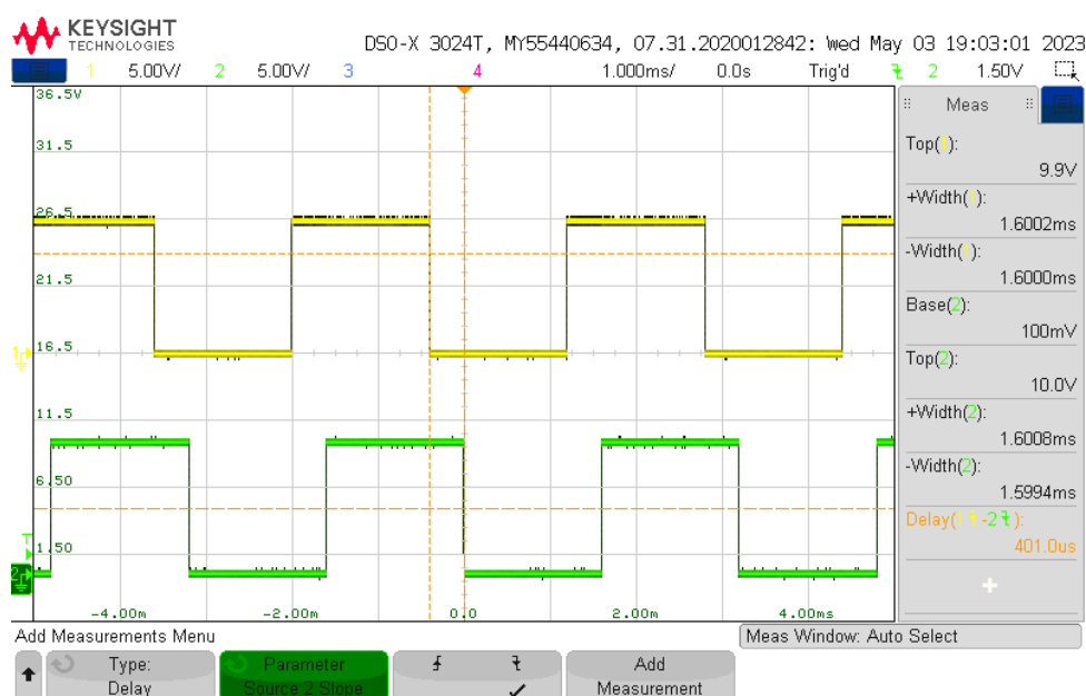
Obrázek 8.1: Analogové výstupy, primární a sekundární se zpožděním, časové základy používané pro testování.
