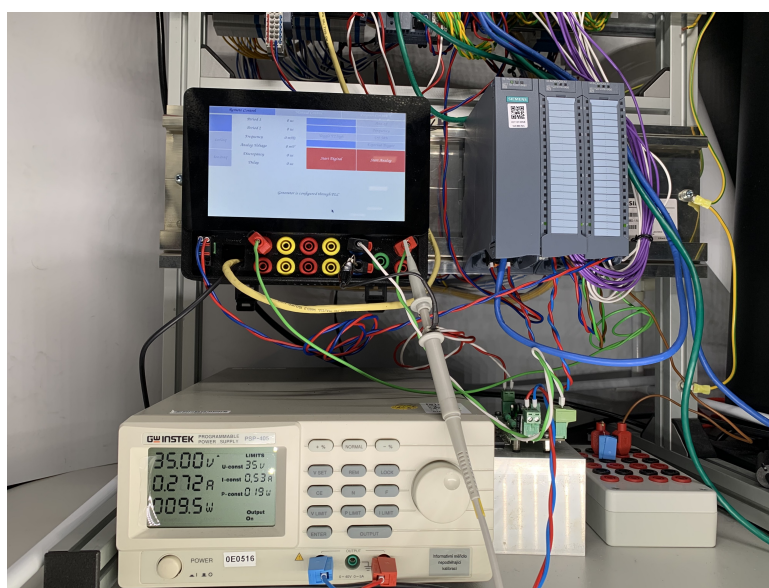
Obrázek 7.15: Generátor zavěšený na DIN liště a připojený k testovanému zařízení.
