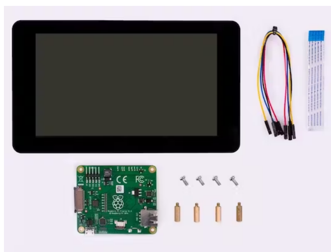
Obrázek 2.3: Sedmipalcový dotykový displej, převzato z [3].
