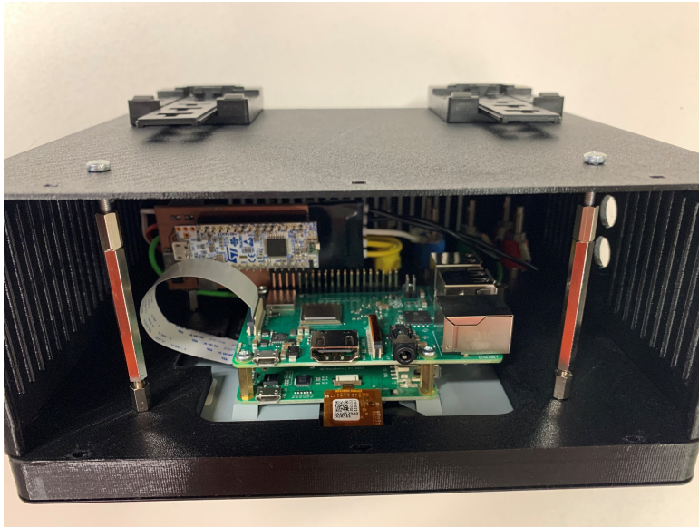
Obrázek 7.14: Vnitřek krabíčky včetně distančních sloupků a šroubů pro zpevnění.
