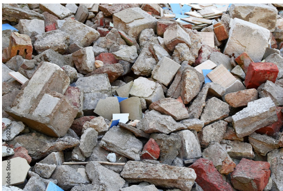
(a) Směs betonu, cihel a kameniva [7]
