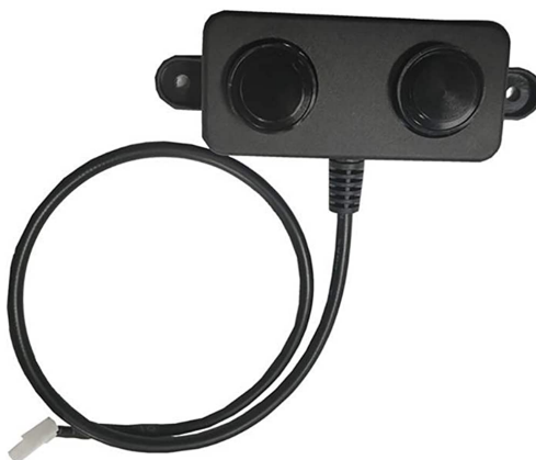
Obrázek 8: Vodotěsný ultrazvukový senzor vzdálenosti HC-SR04 [17]
