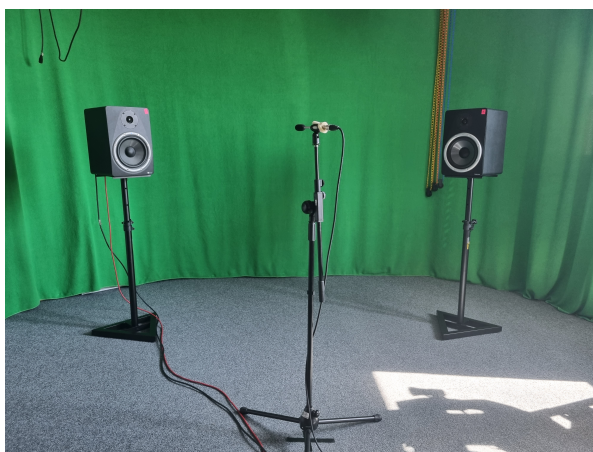
Obrázek 5.1: Měření impulzové odezvy reproduktorů
