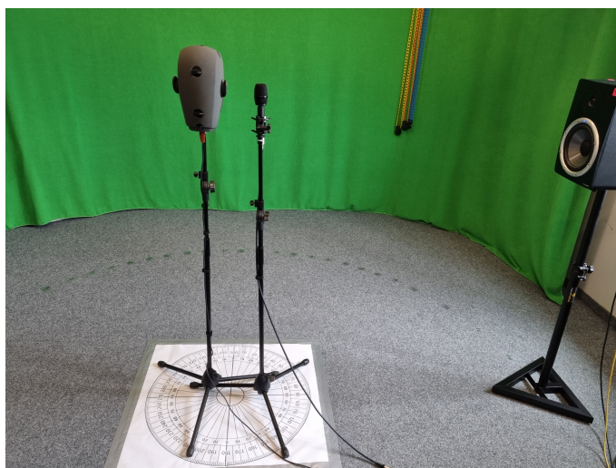
Obrázek 5.3: Ověřování vlivu dvou mikrofonů vedle sebe
