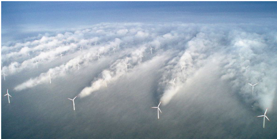
Obrázek 1.5: Rotující proud vzduchu za větrnými turbínami zvýrazněný přítomností zkondenzované vodní páry. Převzato z [8].
