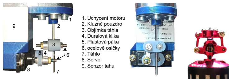
Obrázek 2.3: Detail stavícího mechanismu
