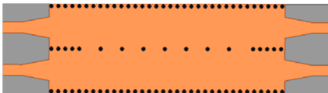
Obrázek 6.6: Model směrové vazby [33].
