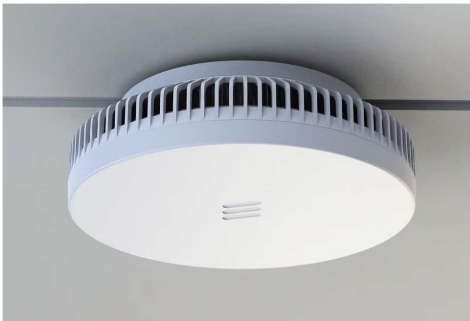
Obrázek 5.2: Radio Dot od firmy Ericsson [38]
