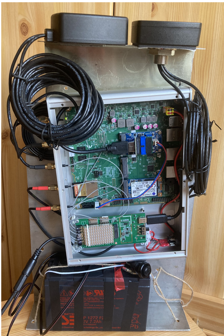
Obrázek 7.3: Měřicí sestava použitá pro měření technologie LTE a 5G
