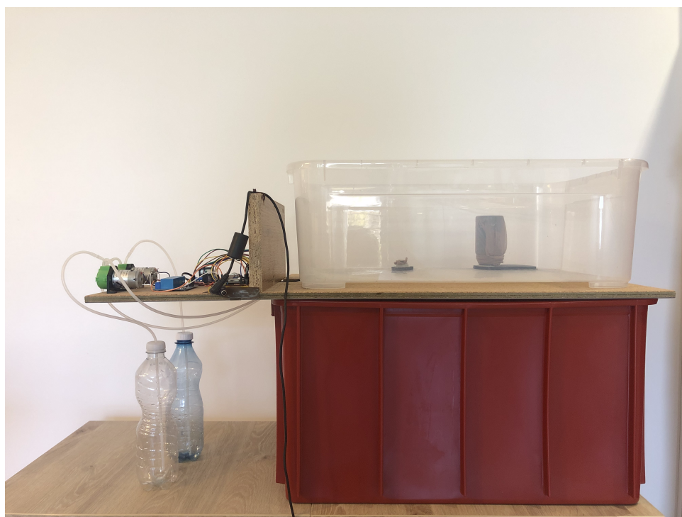
Obrázek 7.2: Boční pohled na prototyp automatického hydroponického systému.
