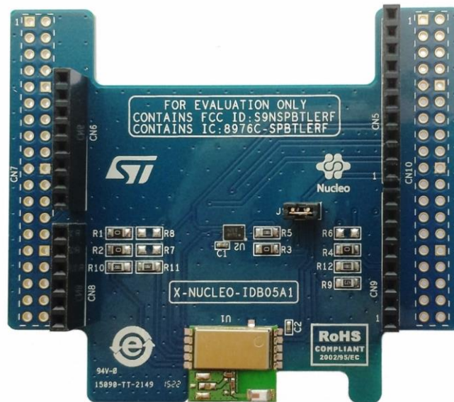
Obrázek 8 – Modul Bluetooth LE typu X-Nucleo - IDB05A1 použitý pro komunikaci mezi ovládacím a promítacím zařízením
