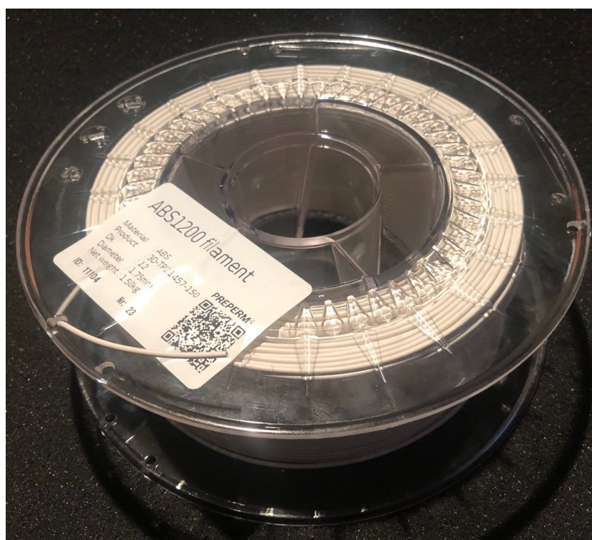
Obrázek 4.2: Dielektrický filament Preperm ABS1200
