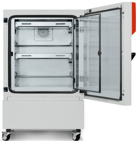
Obrázek 3.3. Pohled dovnitř růstové komory KBWF 240. [16]
