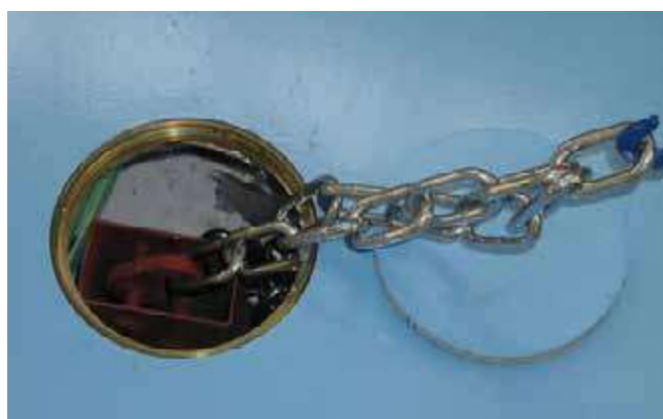
▲ Kotvení nářadí pod podlahou.
