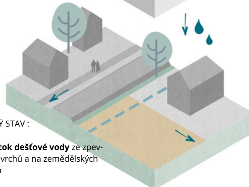
SOUČASNÝ STAV : rychlý odtok dešťové vody ze zpevněných povrchů v intravilánu města
