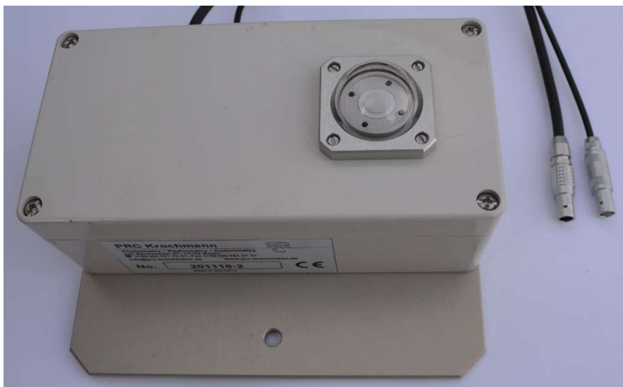
Obrázek 22: Fotometrická hlava typu FET30 – C15 – OI – D8 pro Photometer/Radiometer 211 pro venkovní použití od firmy PRC Krochmann, zdroj: fotoarchiv autora
