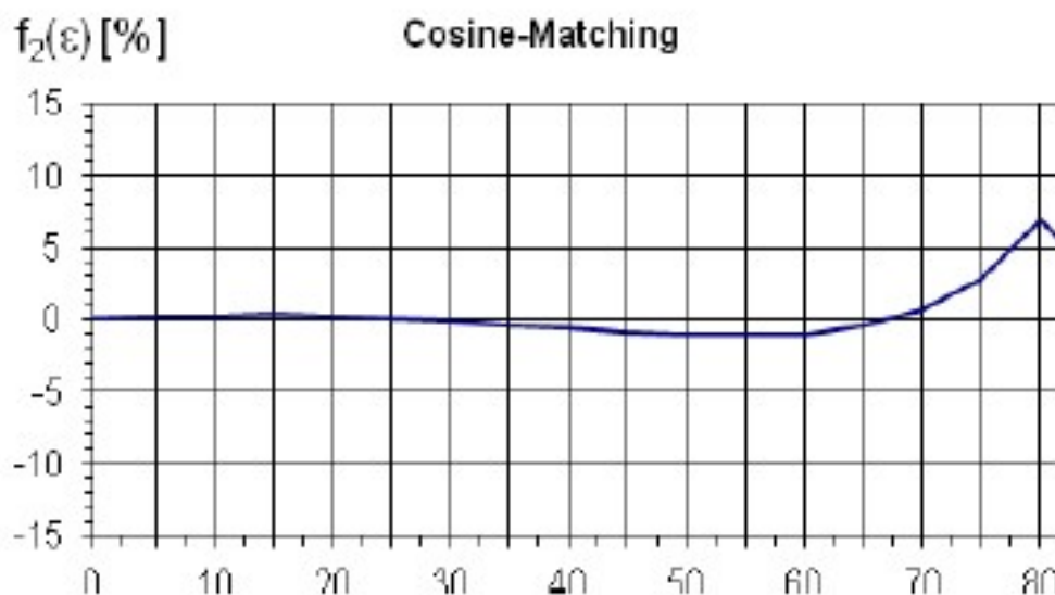
Obrázek 16: RadioLux 111 typická odchylka ve směrové reakci na dopadající záření a hlavu fotometru korigovanou kosinem od společnosti PRC Krochmann, zdroj: technické listy PRC Krochmann
