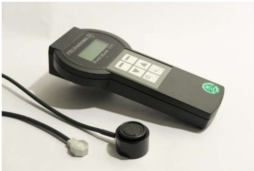
Obrázek 14: Luxmetr RadioLux 111, zdroj: fotoarchiv doc. Ing. Daniela Bošová, Ph.D.
