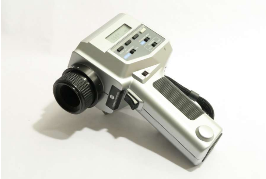
Obrázek 25: jasoměr Konica Minolta LS 110, zdroj: fotoarchiv doc. Ing. Daniela Bošová, Ph.D.
