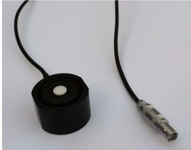
Obrázek 20: Fotometrická hlava typu L pro Photometer/Radiometer 211 od firmy PRC Krochmann, zdroj: fotoarchiv autora
